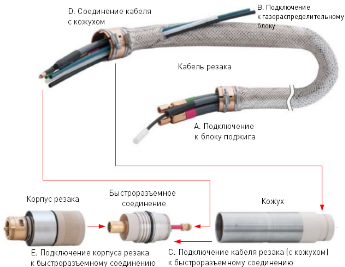
Рисунок 21 – Сборка резака и кабеля.
